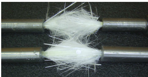
Рис. 4. Вид разрушенных образцов однонаправленного стеклопластика после испытания на одноосное растяжение при пониженных температурах
