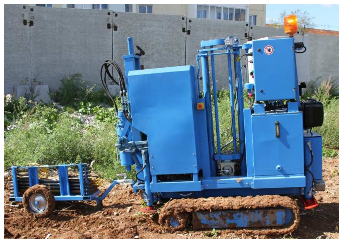
Рис. 2. Установка статического зондирования LWC-100XS
