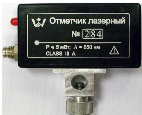
Рис. 4. Отметчик лазерный «ОЛ-4»
