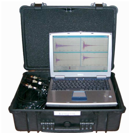
Рис. 1. Многоканальный прибор для измерения и анализа вибрации «Камертон»
