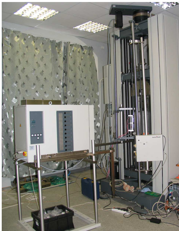
Рис. 1. Общий вид УИМ Zwick – Z250
