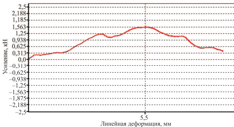
Рис. 3. Зависимость нагрузки от деформации при сжатии образцов-прутков
