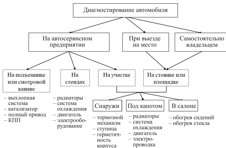
Рис. 2. Варианты применения тепловизионного контроля систем автомобиля
