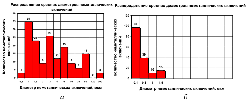
Рис. 4. Статистический анализ загрязненности неметаллическими включениями швов: а – выполненных электродами с рутиловым покрытием ОК 61.30; б – основным видом покрытия ЦЛ 11
