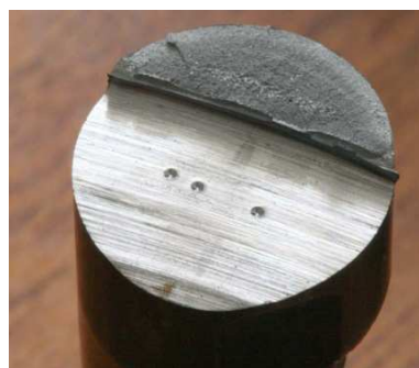
Рис. 3. Следы от измерения твердости, а также участок долома с более светлым упрочненным слоем
