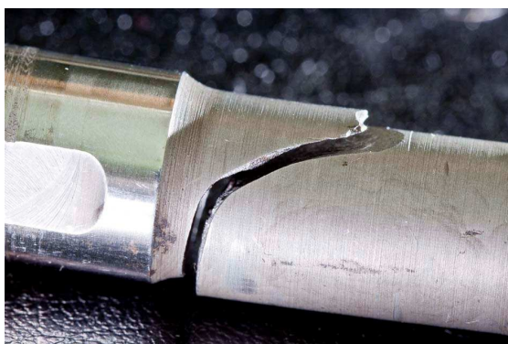
Рис. 11. Совмещение фрагментов оси сателлитов. Фрагмент 1 слева, фрагмент 2 справа
