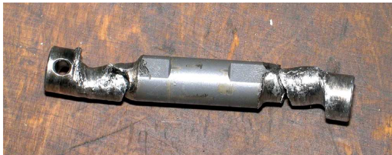
Рис. 4. Ось сателлитов дифференциала автомобиля Mazda 3. Пробег 4800 км
