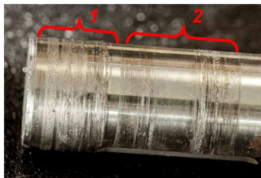
Рис. 10. Фрагмент 1 оси сателлитов имеет следы схватывания и переноса части металла. Зона 1 – место расположения оси в корпусе дифференциала, зона 2 – место расположения сателлита
