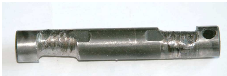
Рис. 1. Ось сателлитов дифференциала автомобиля Ford Focus ST. Пробег 9400 км
