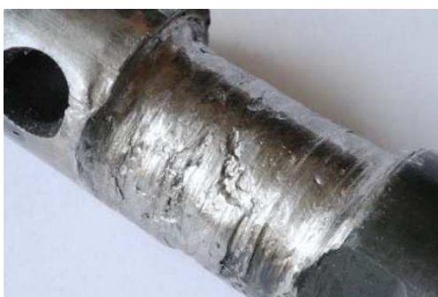
Рис. 2. Часть изношенной оси сателлитов
