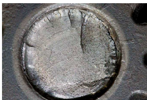
Рис. 8. Излом оси характерен для усталостного разрушения
